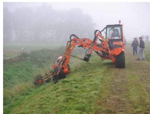
Traktoren mit Messerbalkenmäherwerken oder Kombinationsgeräte sind ökologisch vorteilhafter als Schlegelmäherwerke und sollten daher für das Mähen der Böschungen bevorzugt eingesetzt werden. Auf Geräte mit Absaugeinrichtungen sollte verzichtet werden, sie töten einen Großteil der Kleintierfauna.
